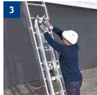
3 Schlitten an der Leiter einhängen und das Seil befestigen.
